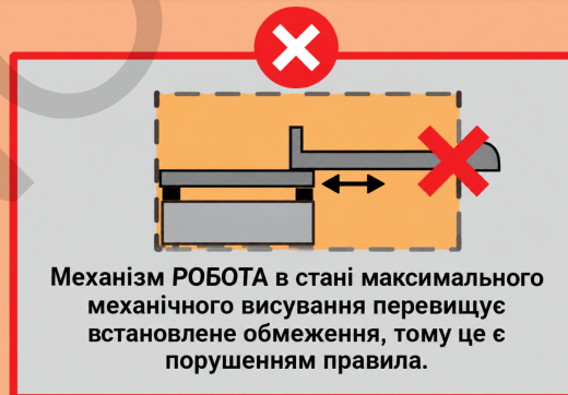
Рисунок 12-3: Обмеження розширення — порушення габаритних обмежень
