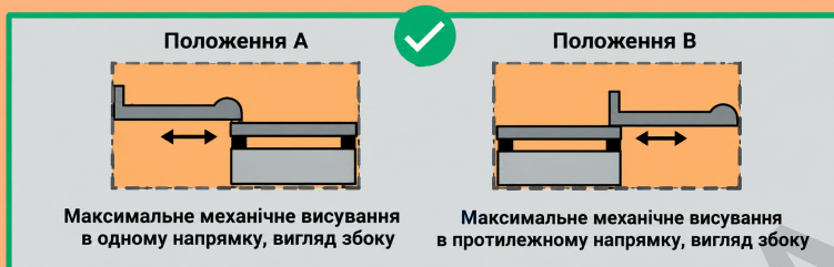
Рисунок 12-4: Обмеження розширення — допустиме висування
